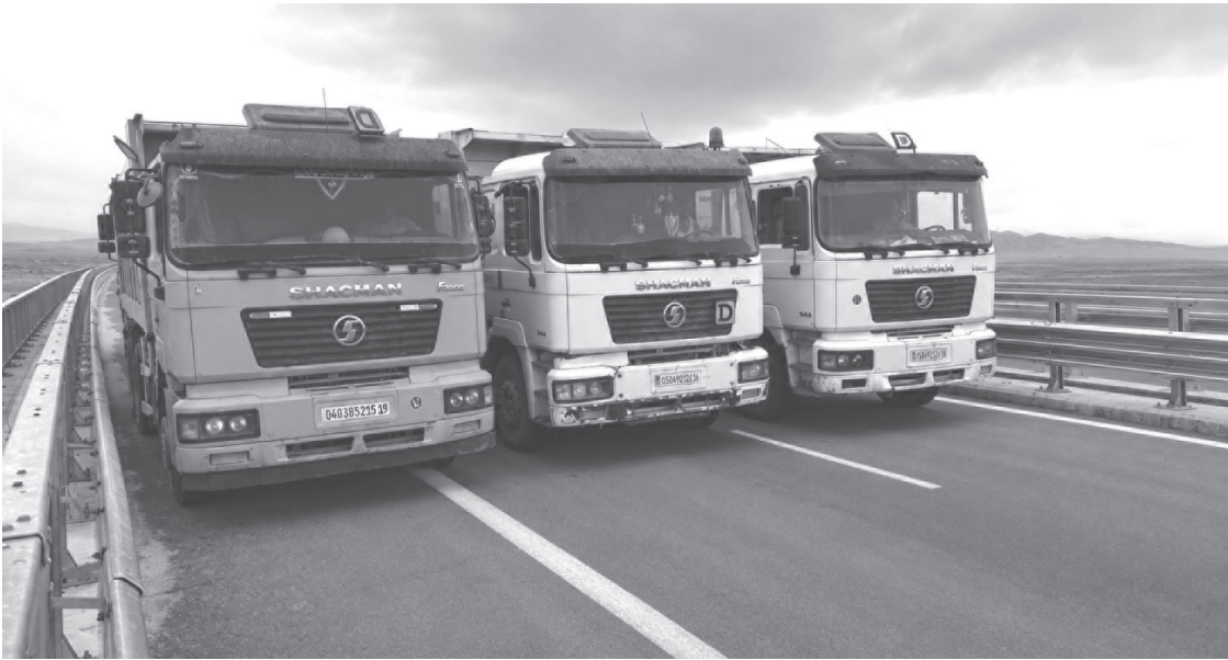
L'ADA mène des essais de chargement sur les ouvrages d'art. (Photo DR)
